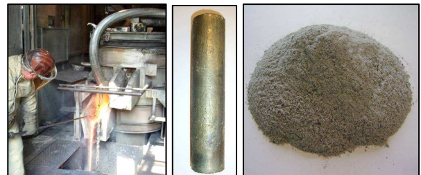
Figure 2 : Chaîne de processus de préparation pyrométallurgique (en haut), coulée au four électrique en arc (en bas, à gauche), lingot d'alliage Co-Ni-Mn (en bas, au milieu), poussières volantes riches en lithium (en bas, à droite).
