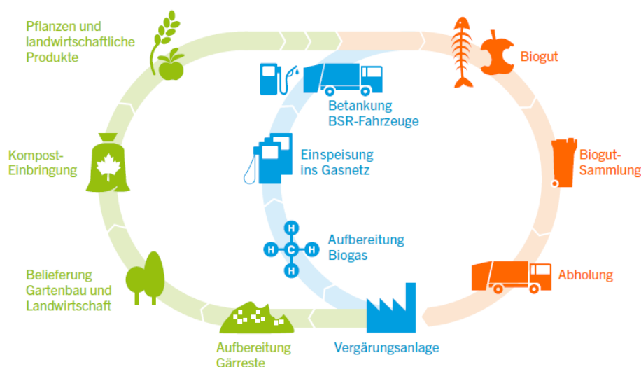
Figure 3 : Schéma de principe du modèle de valorisation de la biomasse urbaine à Berlin. En orange, la collecte et le transport des déchets ; en bleu, la synthèse de biogaz et son injection dans les réseaux existants ; en vert, la valorisation des résidus de digestion dans l'agriculture. Source : BSR - www.bsr.de/bio_abfaelle.php
